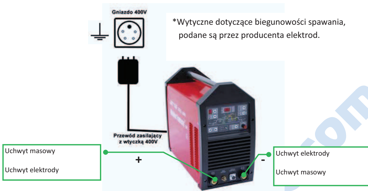
Rys. 6 Spawanie MMA: Schemat podłączenia JET TIG I 315
