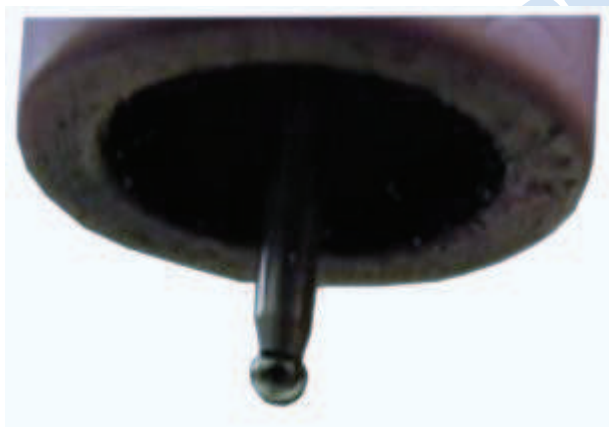
Rys. 43 Elektroda nietopliwa po procesie zaokrąglania
